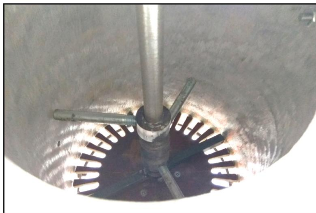
Рисунок 5.2 – Вид рабочей камеры измельчителя изнутри (рабочий вал с установленными штифтами)
