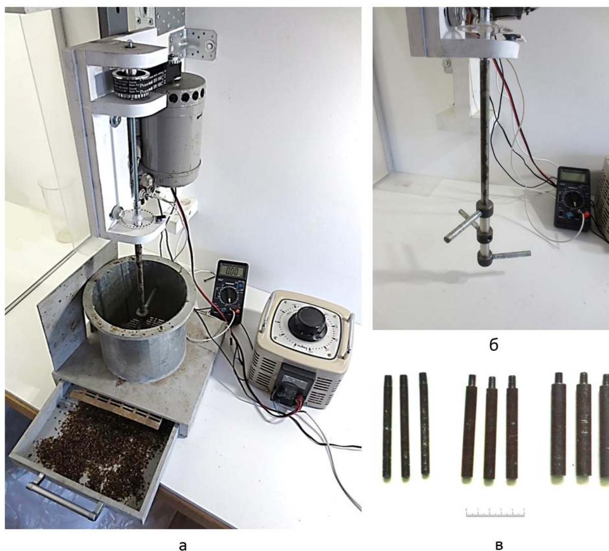
Рисунок 4.3 – Лабораторная установка во время выполнения опытов по измельчению воскового сырья: а – общий вид лабораторной установки; б – рабочий вал с установленными штифтами, закрепленными посредством распорных втулок; в – комплекты штифтов диаметром 10, 12 и 14 мм.
