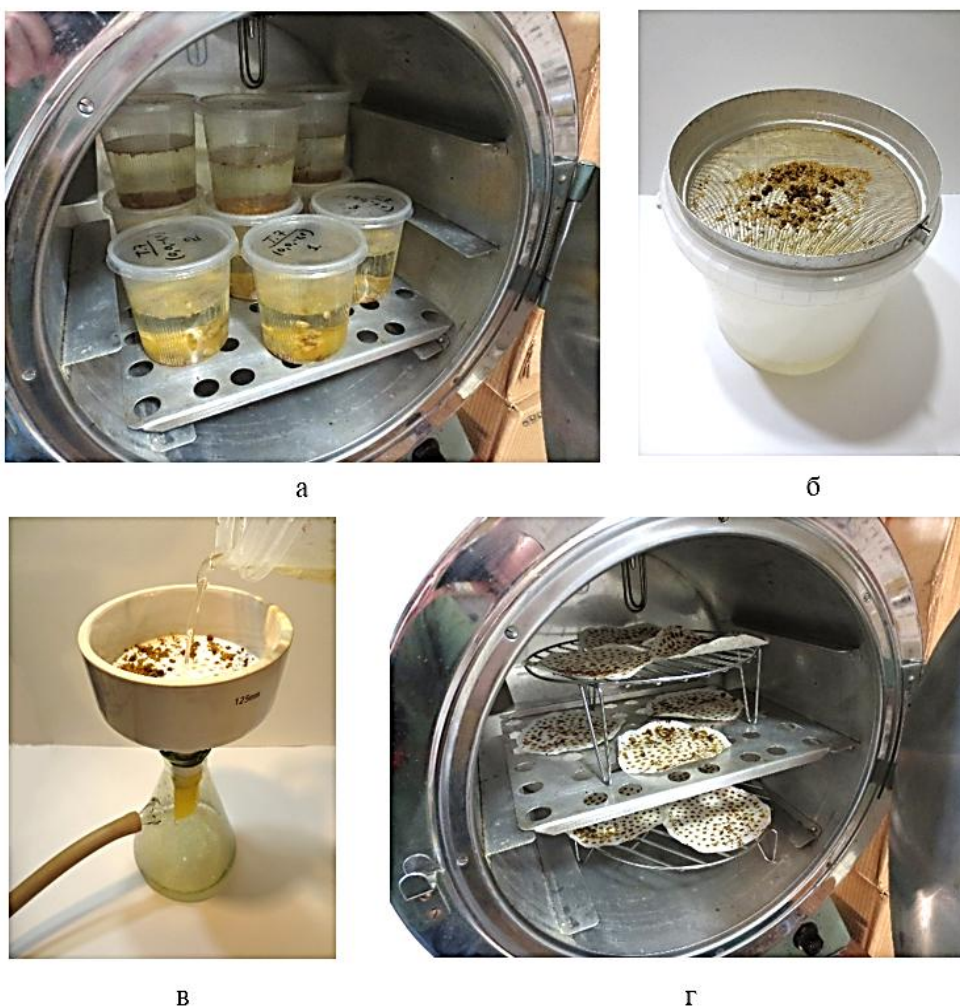
Рисунок 2.5 – Этапы проведения эксперимента по определению влияния времени, и гранулометрического состава на растворимость перги: а – емкости с пробами в воде, помещенные в термостат; б – фильтрование не растворившегося осадка через сито; в – вакуумное фильтрование; г – сушка обеззоленных фильтров с осадком
