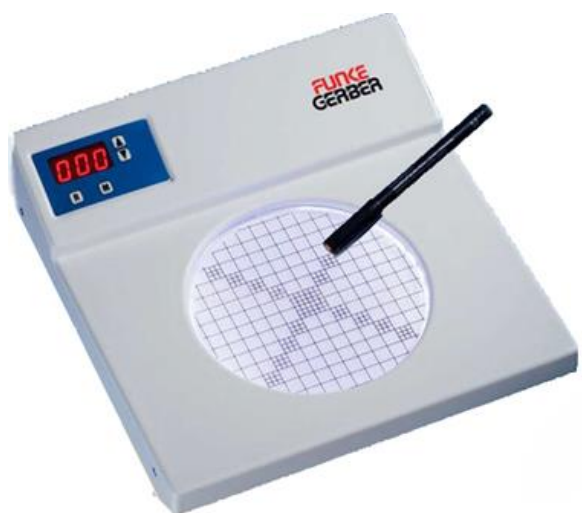
Рисунок 3.11 – Счётчик колониеобразующих единиц Funke-Gerber ColonyStar
