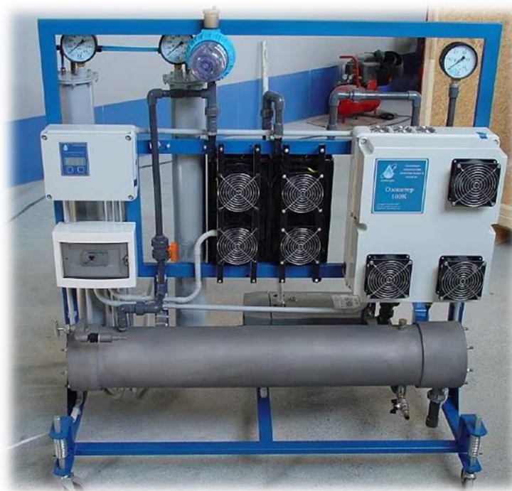
Рисунок 1.29 – Пример исполнения мобильной системы обеззараживания жидких сред озоном
