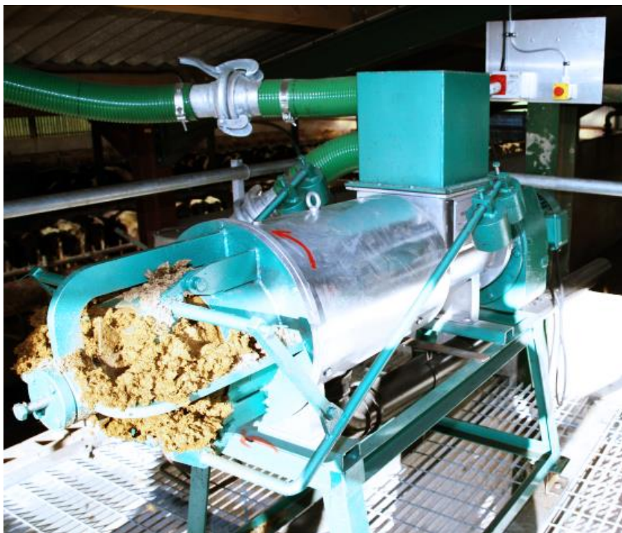
Рисунок 1.17 – Пример сепарации навоза в шнековом пресс-фильтре
