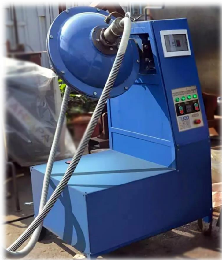
Рисунок 1.26 – Пример исполнения аппарата вихревого слоя от компании Глобалкор
