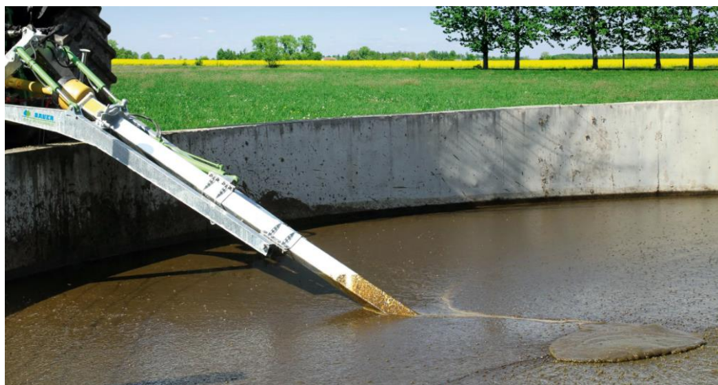
Рисунок 1.16 – Гомогенизации жидкой фракции навоза
