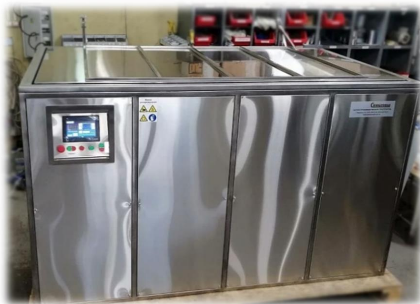
Рисунок 1.21 – Пример исполнения промышленной ультразвуковой ванны с частотой излучателя 25 кГц
