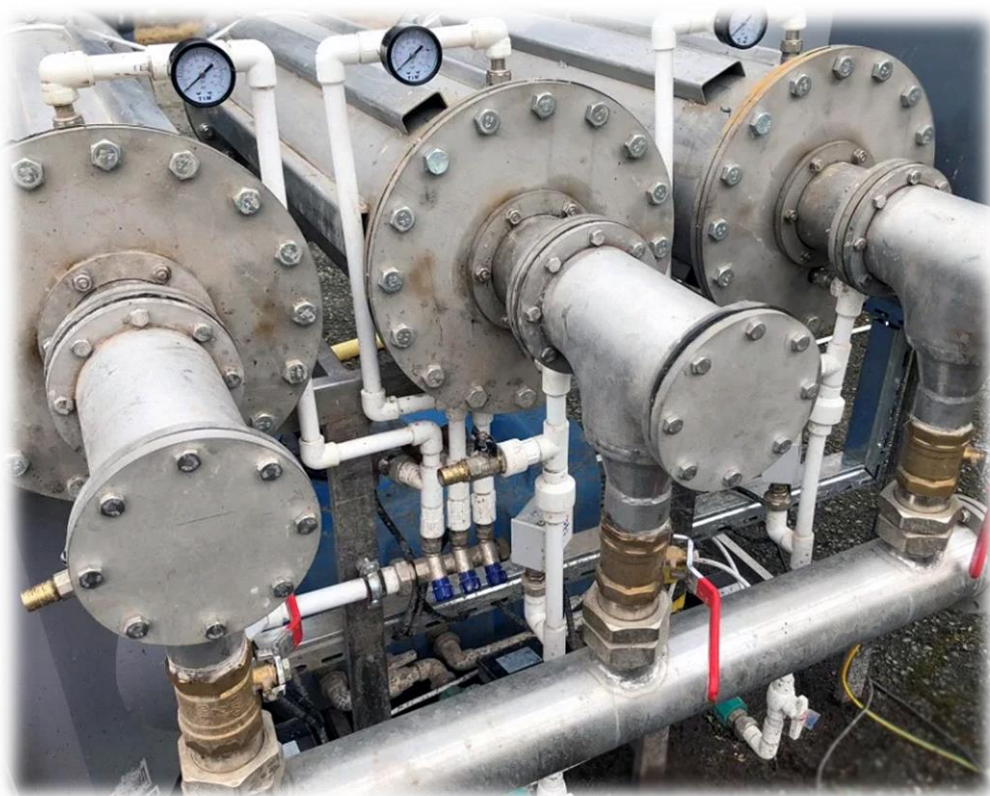
Рисунок 1.27 – Пример параллельного использования аппаратов вихревого слоя в производственных условиях
