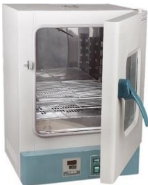
Рисунок 3.10 – Термостат электрический Faithful WGLL-30BE
