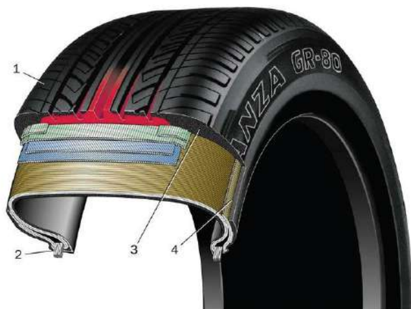
Рис. 18 Конструкция пневматической шины:
