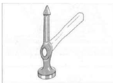
Рис. 2. - Молоток с заостренной рабочей поверхностью.
