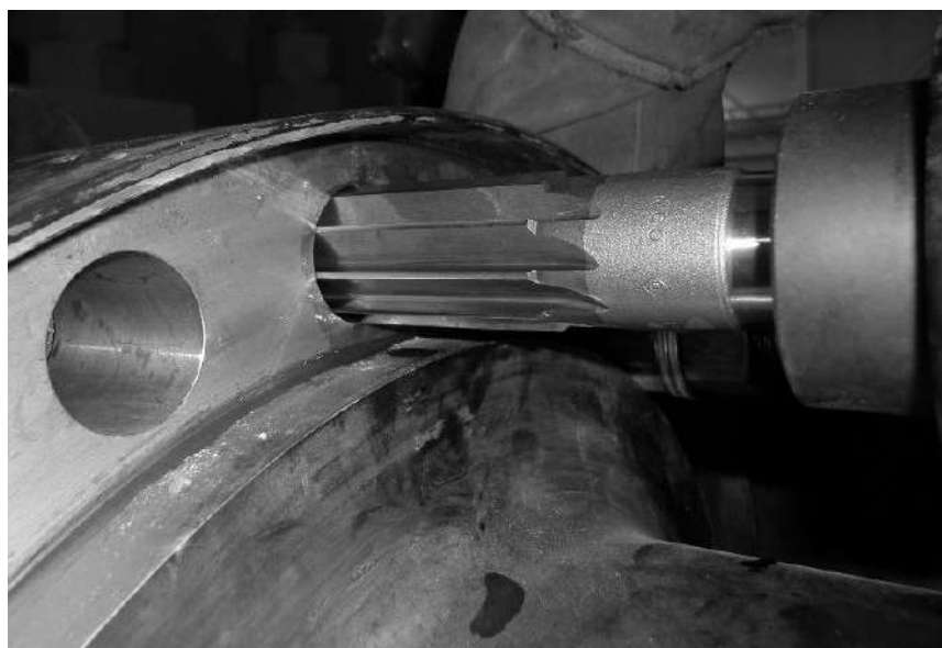
Рисунок 41.2. Развертывание отверстий машинной разверткой
