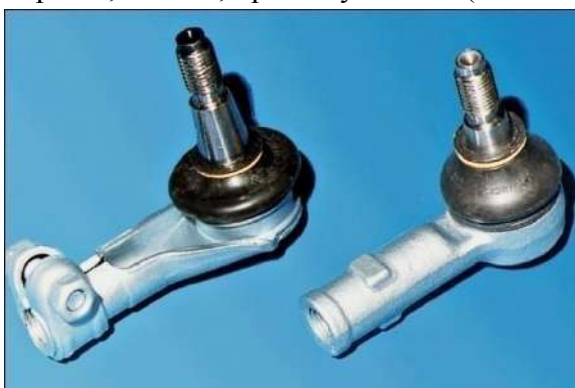
Рис. 32 Шарнир рулевого привода с шаровым пальцем
