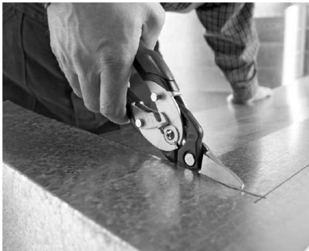
Рисунок 19.2. Положение пальцев на рукоятке при резании ножницами
