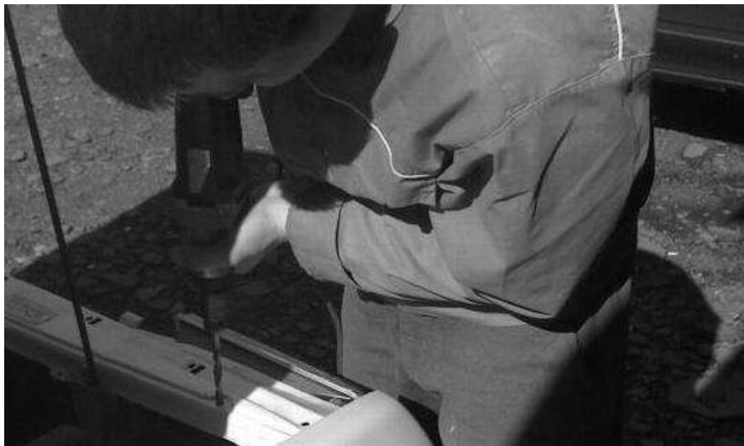
Рисунок 39.1. Прием работы электрической сверлильной машиной.
