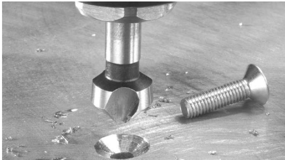
Рисунок 40.2. Коническое зенкерование отверстий
