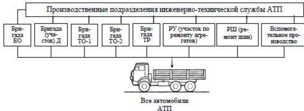
Рисунок 1 – ОПС при организации по методу специализированных бригад
