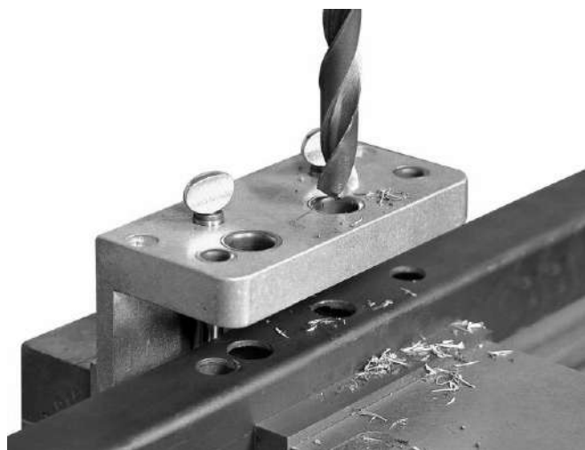
Рисунок 38.2. Сверление отверстий по шаблону
