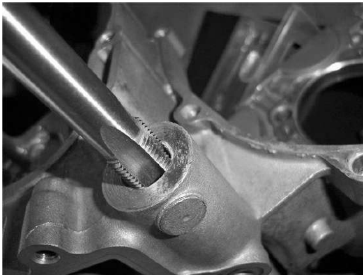
Рисунок 45.2. Нарезание метчиком внутренней резьбы
