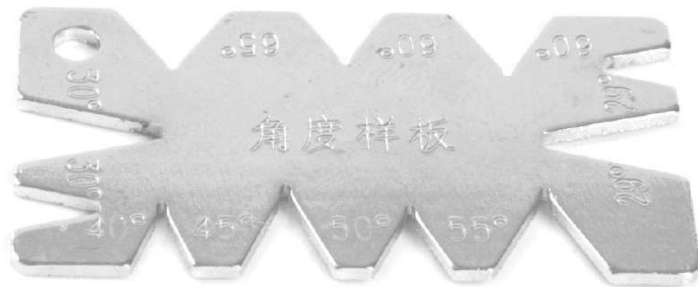
Рисунок 12.2. Шаблон для контроля углов заточки.
