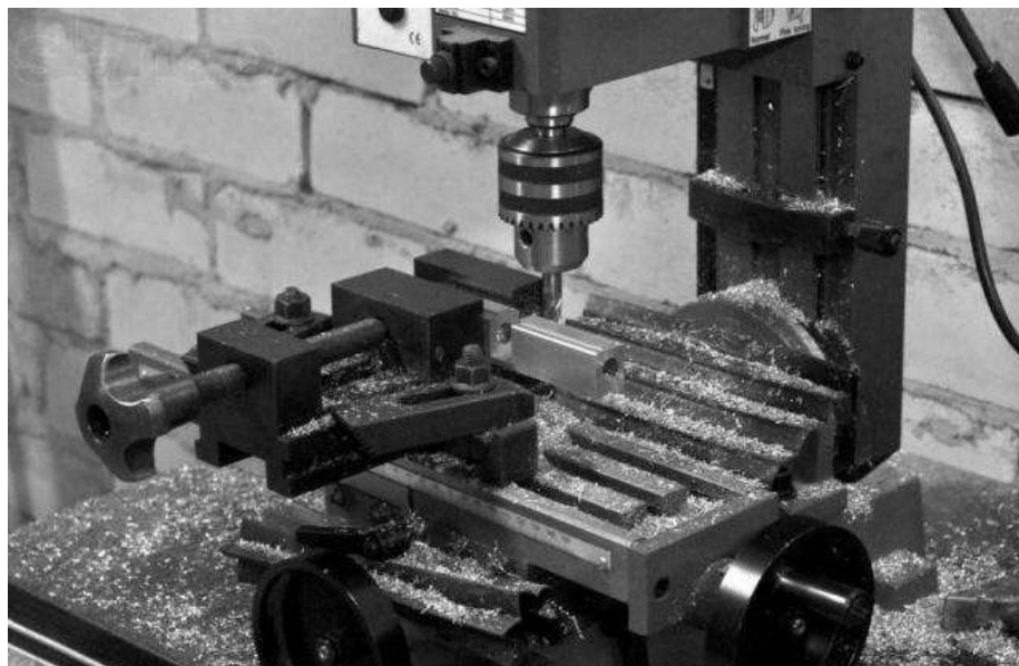
Рисунок 38.1. Сверление заготовки закрепленной в тисках.
