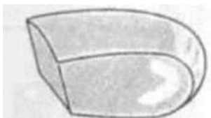
Рис. 8. - Контропора с профилем рельса
