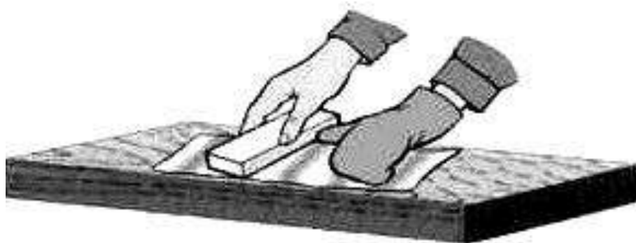
Рисунок 14.3. Правка тонкой листовой стали бруском
