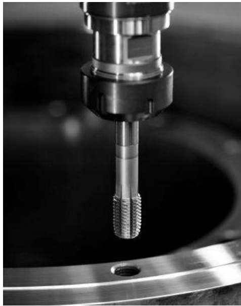
Рисунок 46.2. Прием нарезания резьбы на сверлильном станке.
