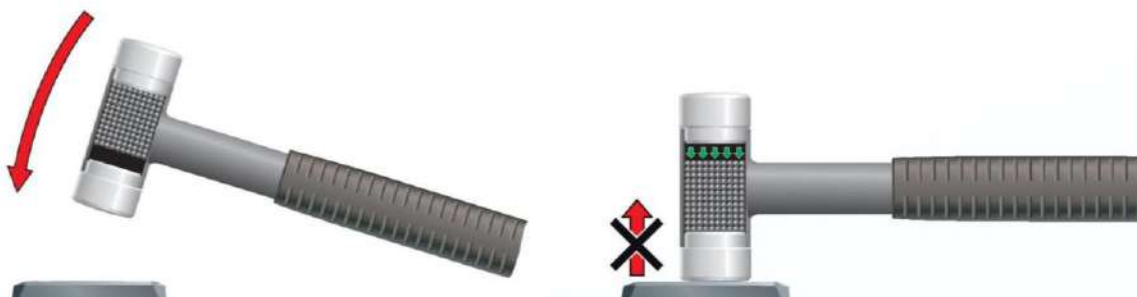
Рисунок 2.2. Принцип работы молотка без отдачи:
