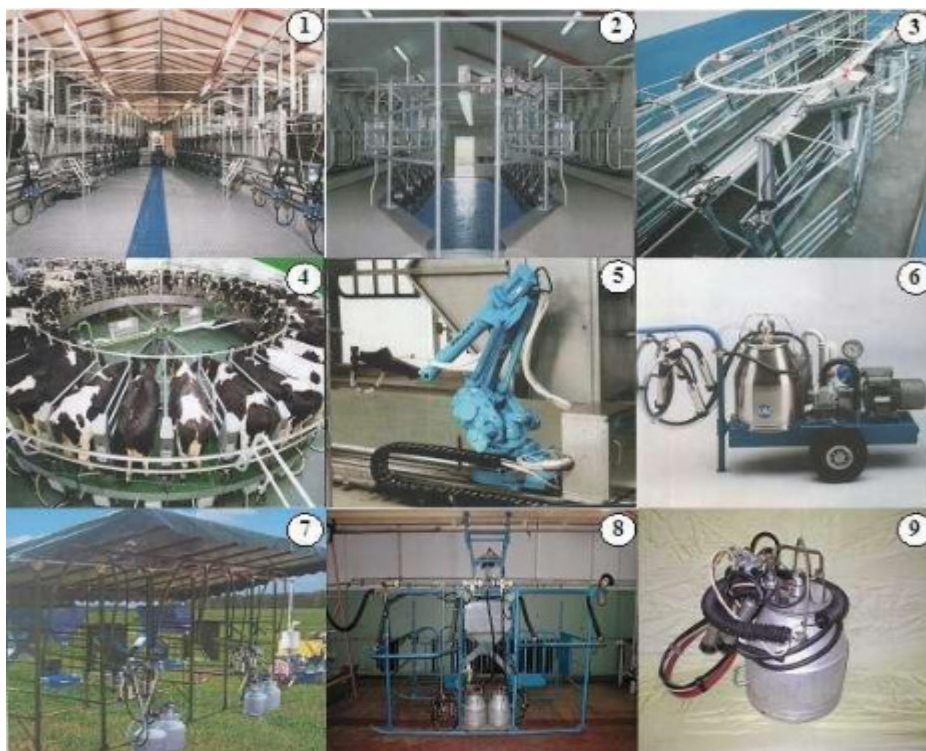
1 – «Параллель»; 2 – «Елочка»; 3 – «Тандем»; 4 – «Карусель»; 5 – доильный робот «SAC»; 6 – мобильная доильная установка; 7 – универсальная (пастбищная) доильная станция типа УДС-3; 8 – выдвижная автоматизированная доильная
