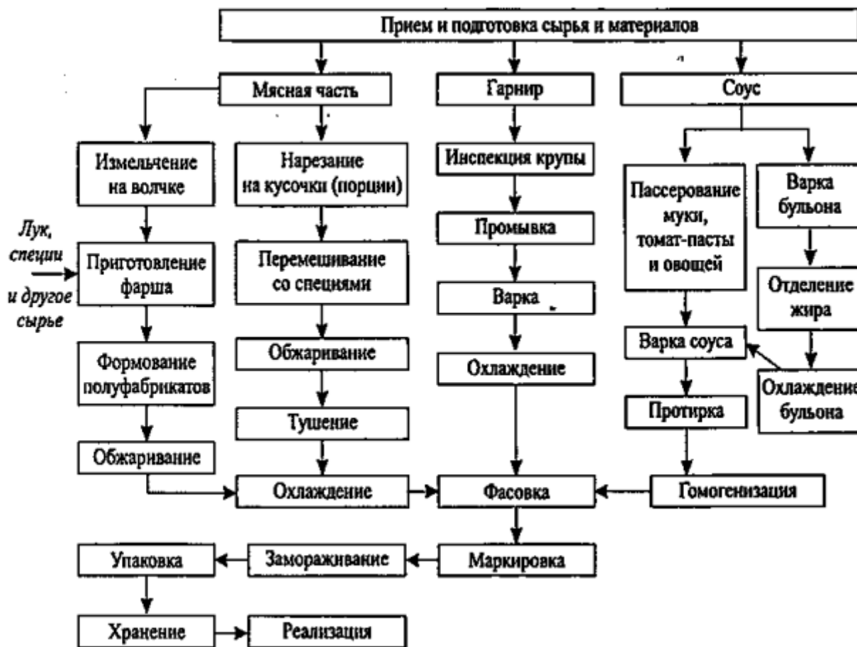
Рисунок 2 – Технологическая схема производства быстрозамороженных готовых мясных блюд
