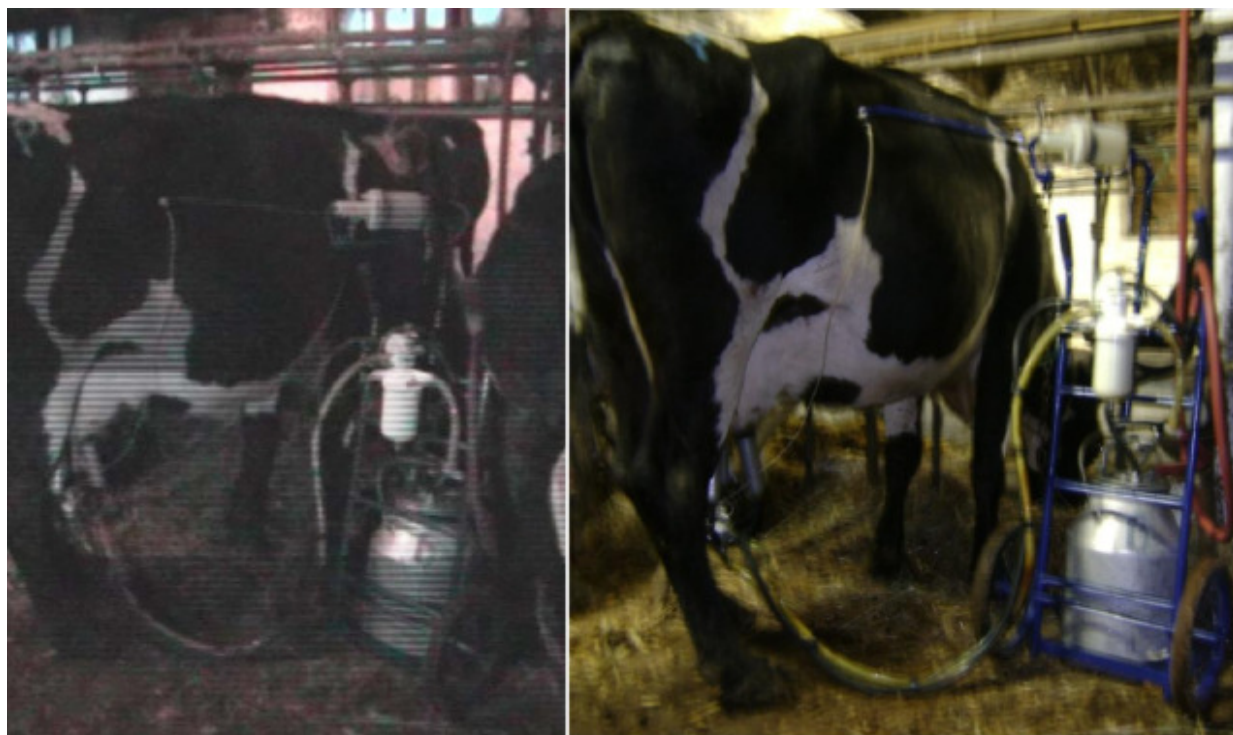
Рисунок 25 – Производственная проверка мобильного доильного модуля в стойлах коровника.
