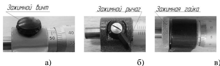
Рисунок 7 – Стопорное устройство: а- винтовое; б- эксцентриковое; в- цанговое.
