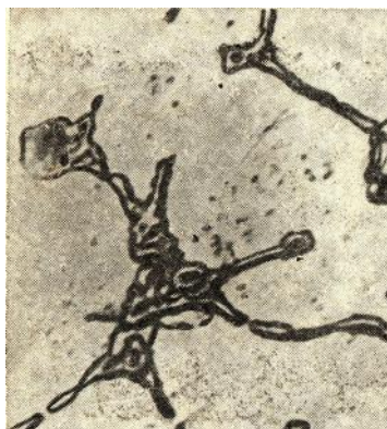
Рисунок 5.5. Микроструктура деформированного алюминиевого сплава Д1 после закалки в воде и естественного старения (X200)
