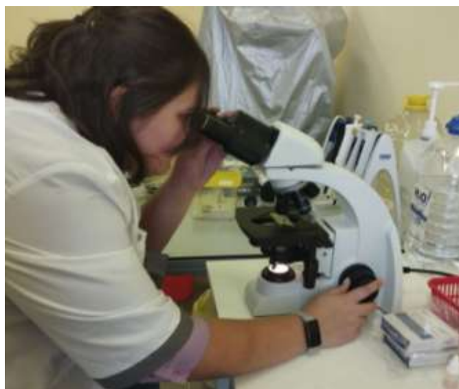
Рисунок 6 – Исследование под иммерсионным микроскопом соскоба на предметном стекле с добавлением капли иммерсионного масла
