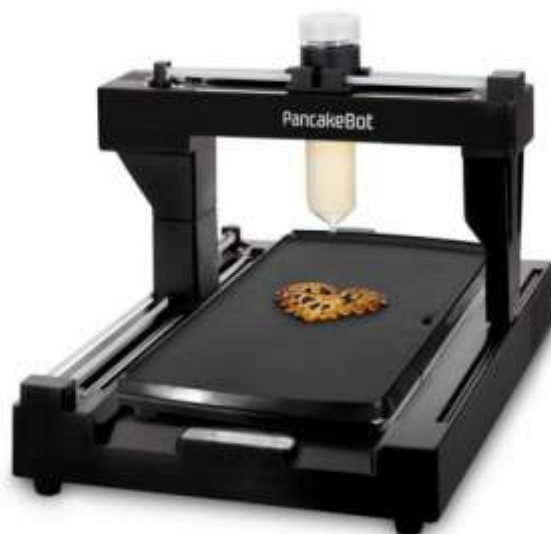
Рисунок 3 –Общий вид пищевого 3D-принтера PancakeBot
