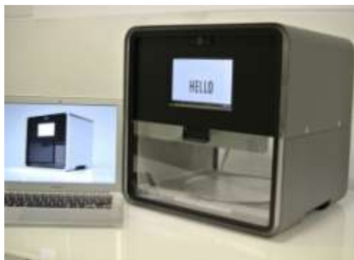
Рисунок 5 – Общий вид пищевого 3D-принтера «Foodini»
